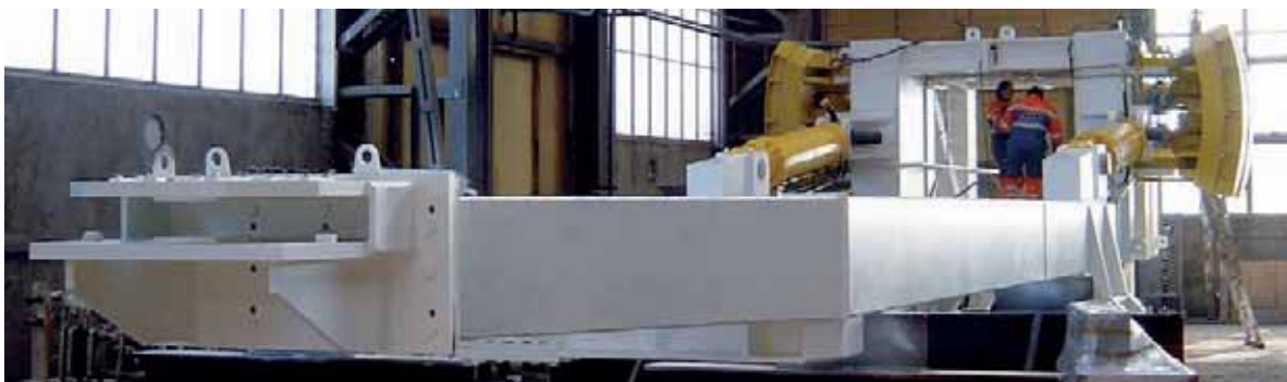
Nachschleppung mit Rückfallsicherung (Werkmontage)
