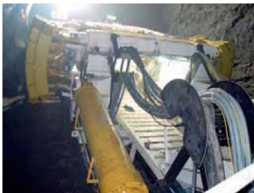
Nachschleppzylinder, Ø 360/180 x 1900, Wandstärke 40 mm
